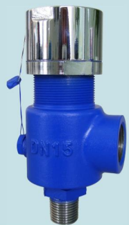
HFA21系列弹簧式安全阀 HFA21 Series spring safety valve 使用介质: 气体、液体 Medium: Gas, liquid Std.:ASME VIII-API 526 Sizes: 1/2"-1" Press.: Class 150Lb ~ 300Lb Temp.: -196°C ~ 200°C
