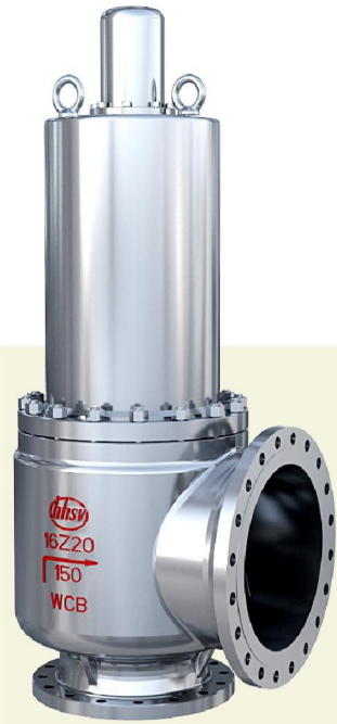
HFO系列弹簧式安全泄压阀 HFO Series spring safety relief valve 使用介质: 气体、液体 Medium: Gas, liquid Std.:ASME VIII-API 526 Sizes: 3/4"-16" Press.: Class 150Lb ~ 2500Lb Temp.: -196°C ~ 300°C
