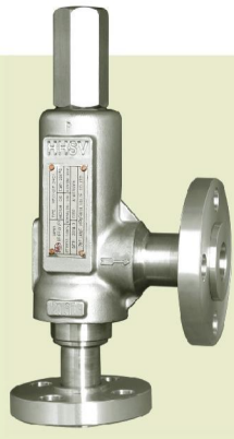
HFXY、HFBPXYL系列弹簧式安全泄压阀 HFXY、HFBPXYL Series spring safety relief valve 使用介质: 气体、液体 Medium: Gas, liquid Std.:ASME VIII-API 526 Sizes: 1/4"-1" Press.: Class 150Lb ~ 600Lb Temp.: -196°C ~ 200°C
